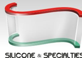
Profili estrusi (pelle sui 4 lati) in silicone espanso platinico, idoneo al contatto con alimenti, a cellule chiuse fini e regolari, colore bianco latte, densità 400 kg/m<sup>3</sup>. Ideali per realizzazione di guarnizioni per il settore agroalimentare e farmaceutico.
